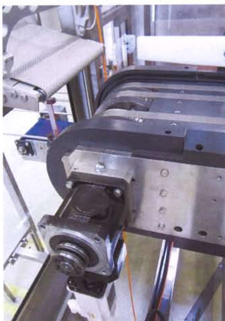
■ Abb. 2: Die 30 mm-Antriebswellen der Umlenkung in der Indag-Portioniereinheit werden in Edelstahl-Rillenkugellagern von Findling Wälzlager gelagert. Die Edelstahl-Wälzlager müssen strenge Hygienevorgaben erfüllen und dem täglichen Washdown mit säure- und laugenhaltigen Reinigungsschäumen sowie Desinfektionsmitteln standhalten. © Wild-Indag
